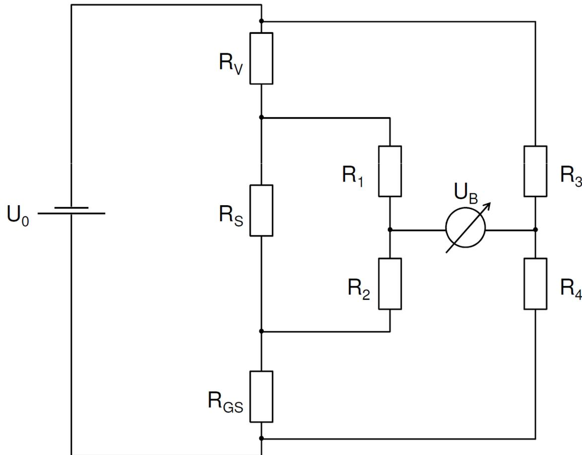
Trennung von Strom- und Spannungspfaden
